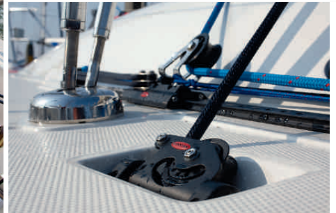
Verdeckte Führung. Die Großschot verläuft unter Deck zurück ins Cockpit. Der Steuermann sitzt gestützt und entspannt, der Mann an den Schoten weniger
