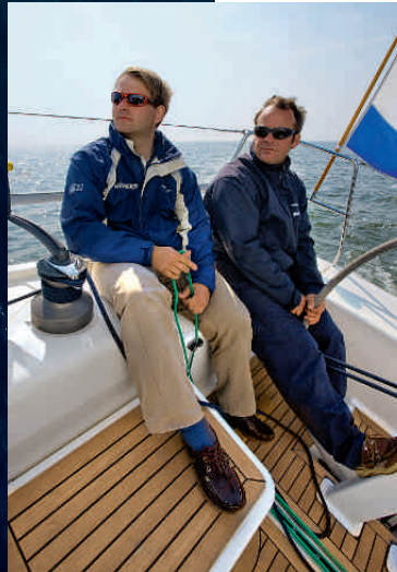
Verdeckte Führung. Die Großschot verläuft unter Deck zurück ins Cockpit. Der Steuermann sitzt gestützt und entspannt, der Mann an den Schoten weniger
